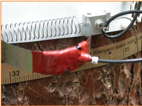
Slika 5: Tračni elektronski dendrometer na deblu jelke.
