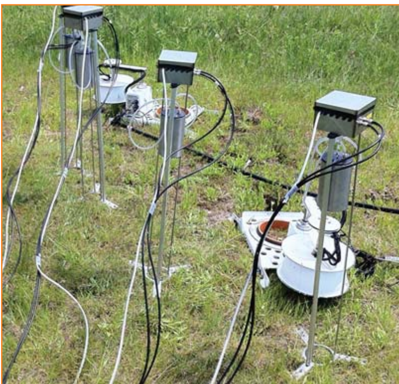
Slika 4: Testiranje sistema za meritev respiracije tal. Sistem je bil razvit v okviru projekta ManFor C.BD. (foto: Mitja Ferlan)
