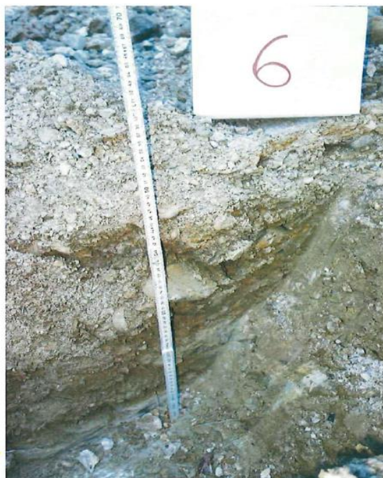
Slika 6: Izvedba sondaže za ugotovitev potrebne debeline zgornjega ustroja.
