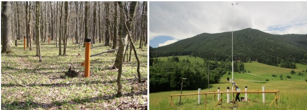
Slika 51: Prikaz vzorčevalnikov za usedline na ploskvah intenzivnega spremljanja gozdnih ekosistemov znotraj sestoja (levo, foto: M. Rupel) in na odprtem (desno, foto: I. Sinjur)
